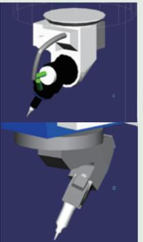
セルや治具は表示・非表示をワンタッチで切り替えられると共に、透明化することもできますので、死角になる箇所のシミュレートも容易に視認できます。
